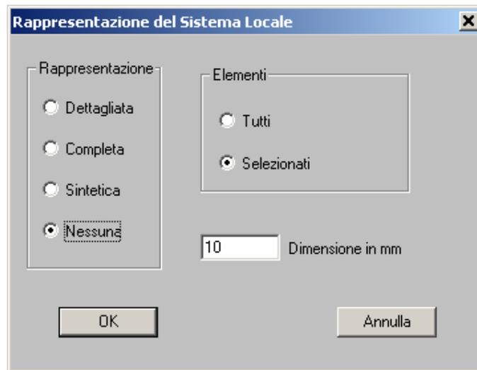
Questo dialogo consente di scegliere se vedere e come vedere la rappresentazione della orientazione locale degli elementi. Si può scegliere se vedere la terna locale completa (completa), se vedere solo la direzione dell'asse 2 (sintetica), se vedere il disegno della sezione in proiezione (dettagliata) o se non vedere affatto l'orientazione (nessuna). E' inoltre possibile scegliere di vedere l'orientazione solo per gli elementi selezionati anziché per tutti gli elementi.
