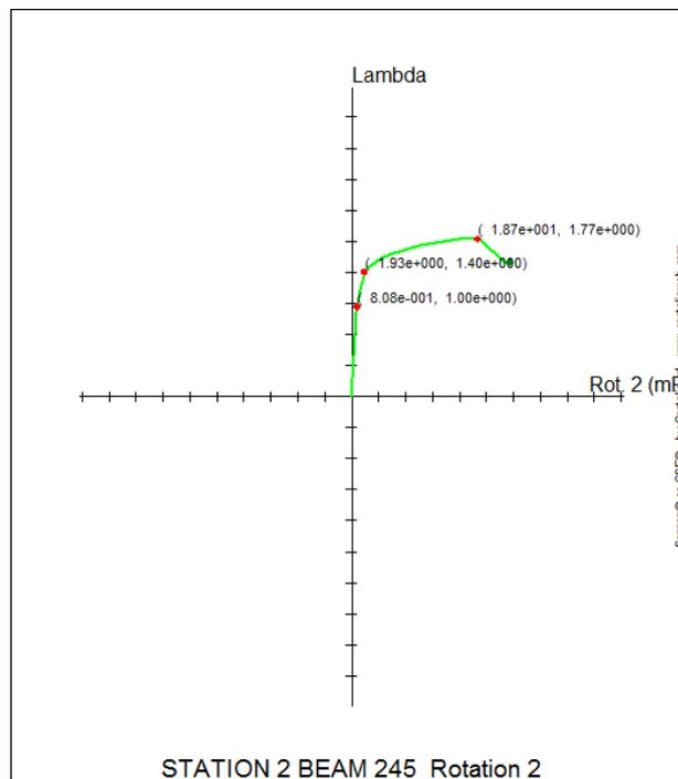
*Rotazione cumulativa delle sezioni di un elemento dissipativo*
